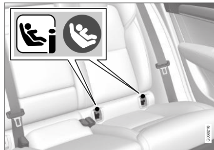
La ubicación de los puntos de fijación se indica con símbolos 2 en el tapizado del respaldo.
