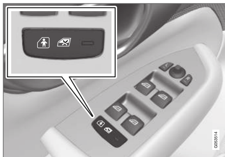
Botón de conexión y desconexión eléctrica.
