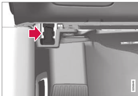
Diagnoseaansluiting (On-board Diagnostic-aansluiting, OBDII) onder het instrumentenpaneel aan de bestuurderszijde.
