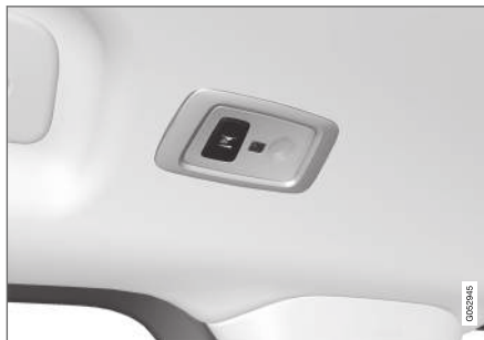
Een auto met panoramadak* is voorzien van twee lampjes: aan beide zijden van het plafond één.
