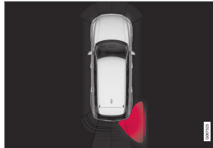
Brandend pictogram voor CTA in de grafische Parkeerhulpsysteem -voorstelling op het display.
