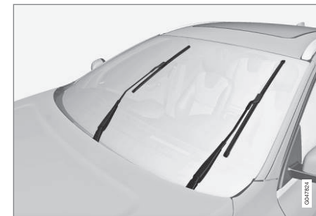
Balais d'essuie-glace en position d'entretien
