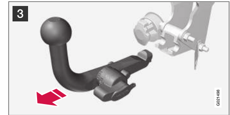
3 Rode o botão de travagem o mais possível. Segure-o nesta posição enquanto puxa a esfera de reboque para trás e para cima.
