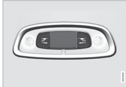
ไฟอ่านหนังสือเหนือที่นั่งแถวที่สอง 13 และที่นั่งแถวที่สาม*
