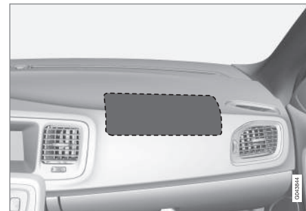
Localização do airbag do lado do passageiro da frente em modelos com volante à esquerda.
