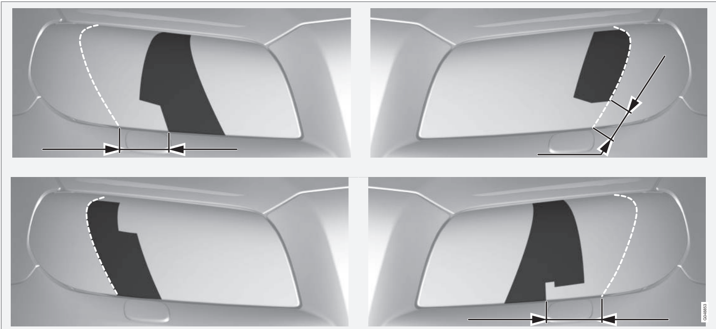
Viršutinė eilutė: automobiliai su vairu kairėje pusėje, A ir B ruošiniai. Apatinė eilutė: automobiliai su vairu dešinėje pusėje, C ir D ruošiniai.
