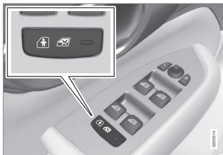
Pulsante di attivazione e disattivazione elettrica.
