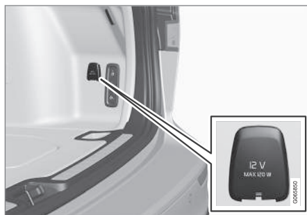
Presa elettrica da 12 V nel bagagliaio*.
