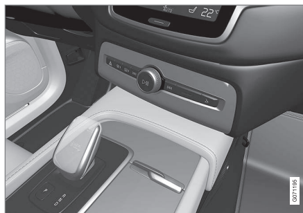
Panoramica della leva del cambio piccola dove non è possibile disattivare l'immobilizzatore della leva selettore.
