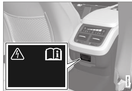
Stroomaansluiting in tunnelconsole, achterin.
