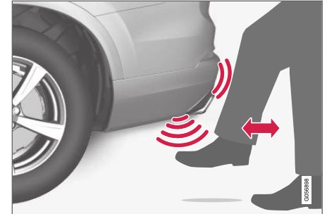
Schopbeweging binnen het geldige activeringsgebied van de sensor.
