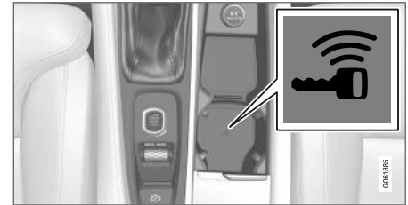
Positie back-uplezer in de tunnelconsole.
