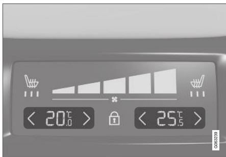
Temperatuurregeling op klimaatpaneel achter op tunnel-console.
