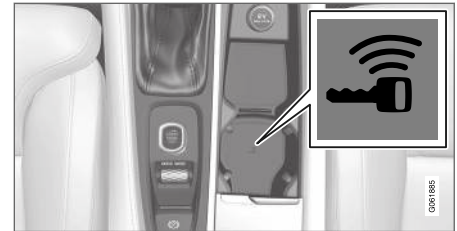
Positie back-uplezer in de tunnelconsole.
