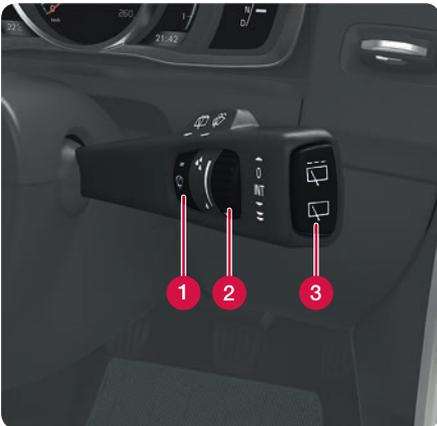
Desplace la palanca hacia abajo para activar los limpiaparabrisas y hacia arriba para realizar un barrido.
