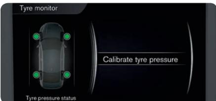
Después de cambiar los neumáticos o modificar la presión de neumáticos, debe realizarse siempre un calibrado. Si se enciende la luz (!) no es necesario controlar la presión de los neumáticos y el sistema se calibra. Proceda de la siguiente manera:
