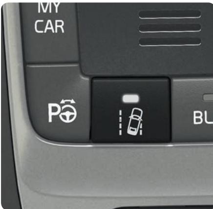
Si el automóvil está a punto de cruzar una línea lateral, el sistema LKA dirigirá activamente el automóvil de vuelta al carril aplicando al volante una ligera fuerza de giro. Si el automóvil traspasa una línea lateral, el sistema LKA avisará al conductor mediante vibraciones en el volante.
