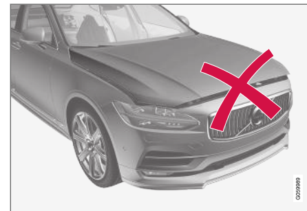
Cofano non completamente chiuso.
