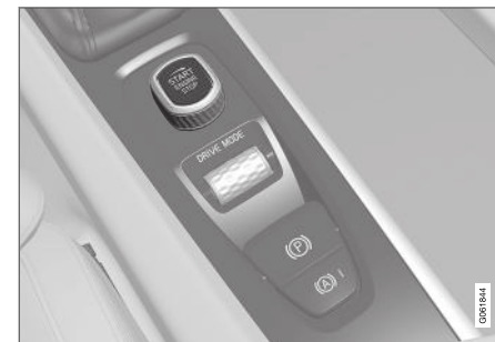
Interruttore di avviamento nel tunnel.
