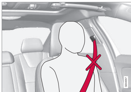
Forkert placeret sikkerhedssele. Selen skal ligge mod skulderen.
