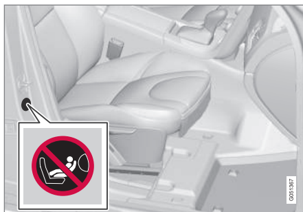
Mulighed 2: Placering af airbaggens mærkat på passagersidens dørstolpe. Mærkatet bliver synlig, når passagerdøren åbnes.
