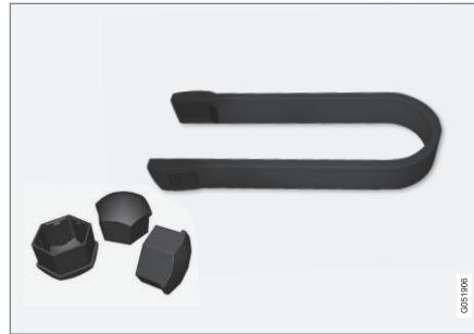
Værktøj til at fjerne hjulboltenes plastkapsler.
