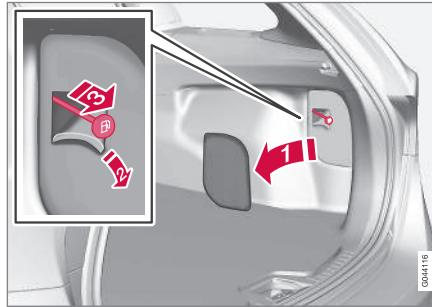
1. Abra y retire la tapa lateral en el maletero (en el mismo lado que la tapa del depósito).
