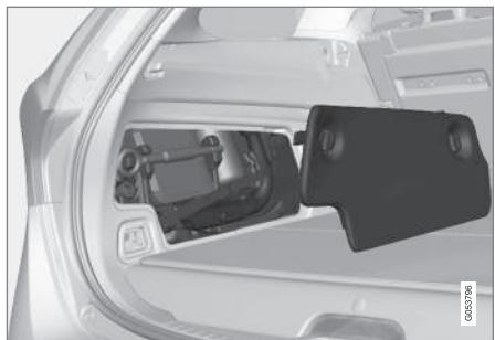
Las herramientas del vehículo se guardan en el compartimento lateral del maletero.
