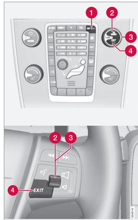
Panel de control en la consola central y teclado del volante. La figura es esquemática. El número
