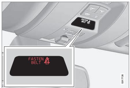
El aviso acústico depende de la velocidad y, en algunos casos, del tiempo. La señal lumínosa se puede ver en la consola del techo y en el cuadro de instrumentos (p. 68).
