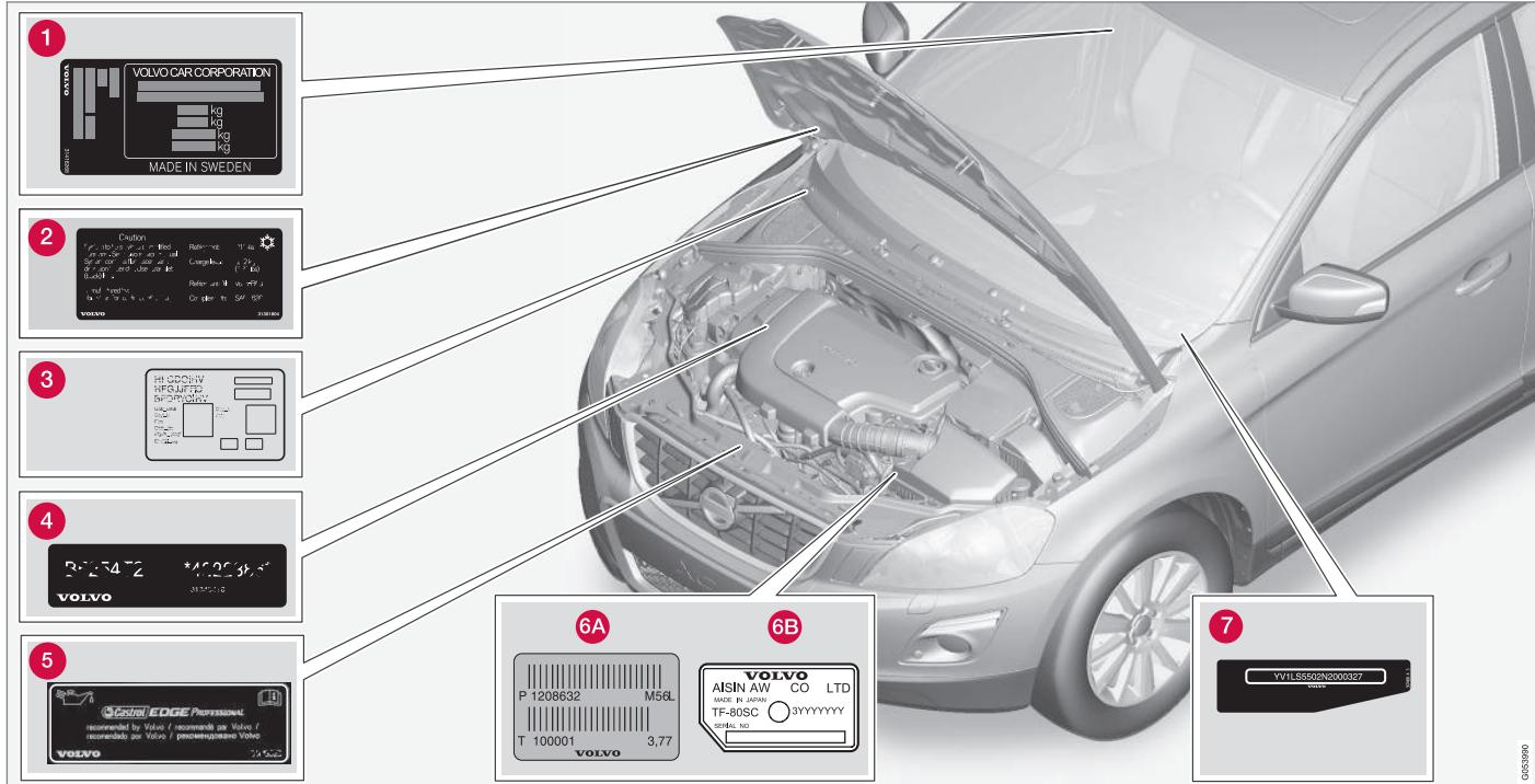
*La imagen es esquemática. Los elementos pueden variar según el mercado y el modelo.*
