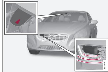
*Sensor de cámara y de radar<sup>22</sup>.*
