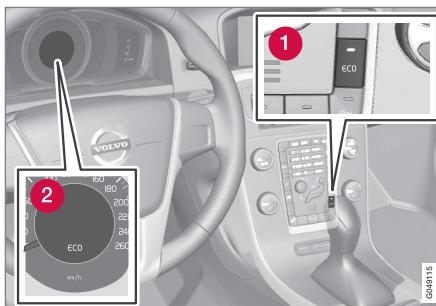
① Conexión y desconexión de ECO
