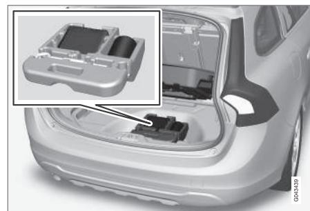
El kit de reparación de neumáticos está debajo del piso del maletero.
