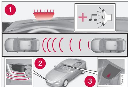
1. El testigo y la señal acústica del aviso de colisión<sup>8</sup>.
