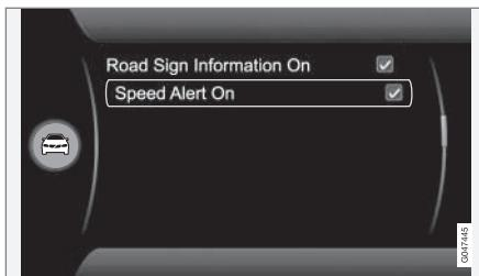
El conductor puede optar por recibir una advertencia en caso de rebasar el límite de velocidad vigente en 5 km/h (5 mph) o más. La advertencia se presenta a través del parpadeo temporal del símbolo con el límite de velocidad aplicable al superarse ésta. El sistema puede conectarse y desconectarse en el sistema de menús **MY CAR**. Para una descripción del sistema de menús, véase **MY CAR** (p. 122).
