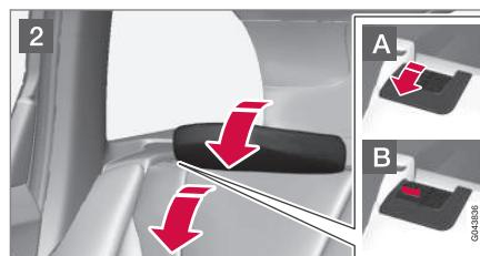
1 Para abatir la sección central, libere y baje el reposacabezas del respaldo central, véase el apartado "Reposacabezas central trasero".
