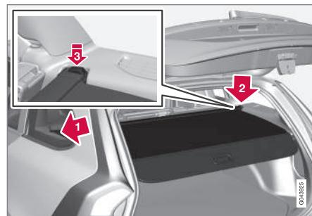
Coloque el cubreobjetos sobre la carga y fíjelo en las ranuras situadas en los montantes traseros del espacio de carga.
