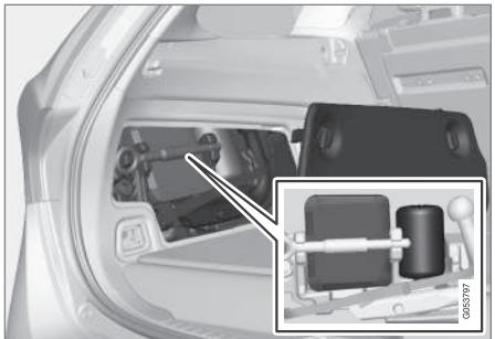
El kit de reparación de neumáticos se guarda en el compartimento lateral del maletero.
