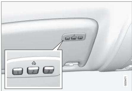
HomeLink®<sup>28</sup> es un mando a distancia programable que puede controlar hasta tres dispositivos diferentes (por ejemplo, la puerta del garaje, el sistema de alarma, la iluminación exterior e interior, etc.) y utilizarse por tanto en lugar de los mandos a distancia correspondientes.
