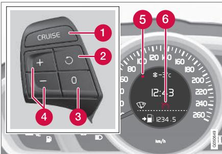
Teclado de volante y cuadro de instrumentos en vehículo **sin** limitador de velocidad<sup>4</sup>.
