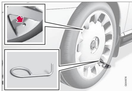
5. Atornille la anilla de remolque con la llave para tornillos de rueda\* hasta el tope.
