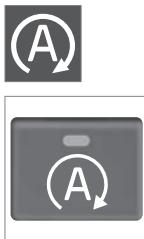
La función Start/Stop se activa automáticamente al arrancar el motor con la llave. El sistema avisa al conductor encendiendo el símbolo de la función en el cuadro de instrumento y encendiéndola la luz del
