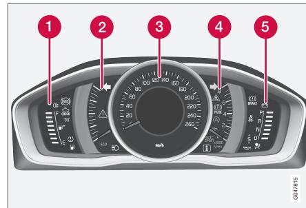
1 Indicador de combustible. Cuando la indicación se reduce a una sola señal blanca<sup>1</sup>, se enciende el símbolo de control de bajo nivel en el depósito de combustible. Véase también Centro de Información Electrónico (p. 123) y Llenado de combustible (p. 329).
