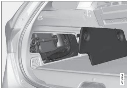
La anilla de remolque se guarda junto con las herramientas en un compartimento lateral en el maletero.
