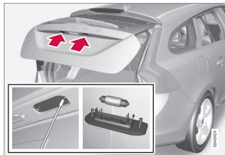
1. Suelte los tornillos con un destornillador.
