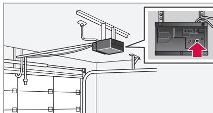
4. Busque el "botón de memorización<sup>29</sup>" en el receptor de, por ejemplo, la puerta del garaje, que suele estar situado cerca de la fijación de la antena en el receptor.
