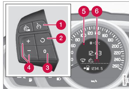
Teclado de volante y cuadro de instrumentos en vehículo **con** limitador de velocidad<sup>4</sup>.
