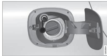
1. Abra la portezuela del depósito y retire la tapa protectora del racor.
