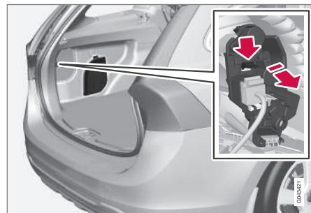
*Las bombillas de las luces de marcha atrás, las luces antiniebla y los intermitentes traseros se cambian dentro del compartimento de carga.*
