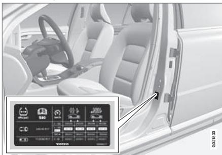
La placa de presión de neumáticos situada en el montante de la puerta del lado del conductor (entre la puerta delantera y la trasera) especifica la presión que deben tener los neumáticos en diferentes condiciones de carga y velocidad. Estos datos se indican también en la tabla de presiones de neumáticos, véase Neumáticos - presiones de inflado aprobadas (p. 463).
