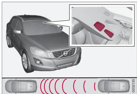
Ventanas del emisor y el receptor del sensor láser<sup>14</sup>.
