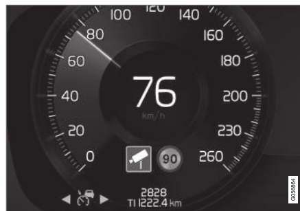
Información sobre cámaras de control de velocidad en la pantalla del conductor 105 .
