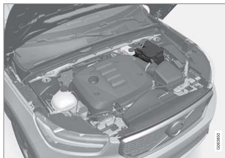
起動電瓶位於引擎室中。
