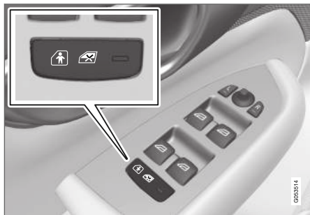
Botón de conexión y desconexión eléctrica.
