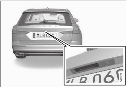
A tampa do porta-malas mantém-se fechada através de uma trava elétrica.
