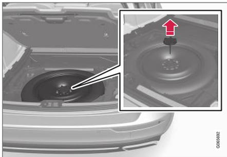
O pneu sobressalente está na aparadeira do pneu sobressalente com o lado de fora virado para baixo. O bloco de espuma contém todas as ferramentas necessárias para a substituição da roda.
