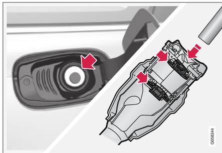
É importante abastecer o bico da bomba mais do que as duas aberturas do tubo de enchimento antes de iniciar o abastecimento do veículo.
