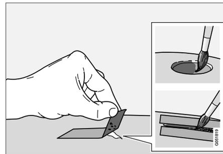
1. Fixe um pedaço de fita adesiva sobre a superfície danificada. Em seguida, puxe a fita de modo que os eventuais restos da tinta venham presos à fita.
