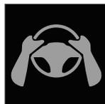
Se o Pilot Assist detectar que o motorista não tem as mãos no volante, o motorista é alertado após um breve período para acionar a direção do veículo, com um símbolo e uma mensagem de texto.
