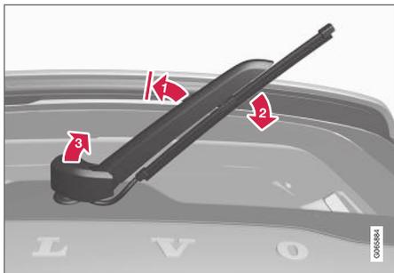
Levante o braço dos limpadores do para-brisa do vidro e puxe a parte superior da palheta do limpador diagonalmente para a direita.
