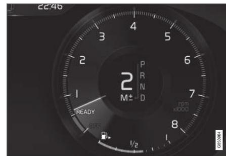
O modo manual pode sempre ser selecionado a qualquer momento durante a condução. O motor freia quando se solta o pedal do acelerador.
