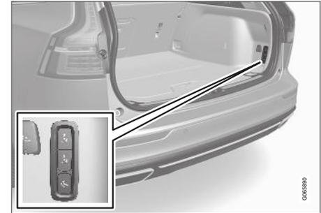
Abra a tampa do porta-malas. Na parte de trás do painel lateral direito da área de carga existe um botão para retração e rebatimento da barra de reboque. Para que a função de rebatimento esteja ativa é necessário que esteja acesa uma luz indicadora laranja no botão.
