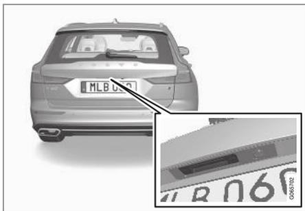
A placa de pressão na tampa do porta-malas só pode ser usada para destravamento.
