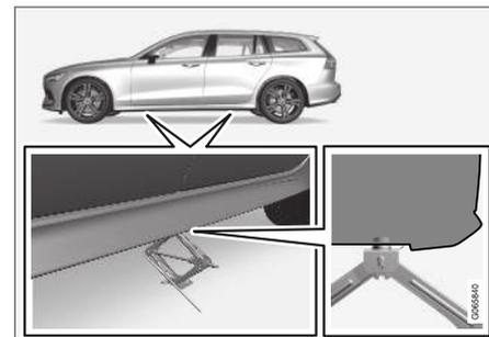
9. Coloque o macaco sobre uma superfície plana, sólida e não escoregada sob o ponto de fixação a ser usado.
