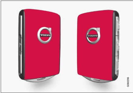
Uma Red Key pode definir a velocidade máxima do veículo, gerar lembretes de velocidade e determinar o volume máximo do sistema de alto-falantes. Além disso, alguns dos sistemas de suporte ao motorista do veículo ficam sempre ativos. As demais funções da chave são as mesma que em uma chave normal.
