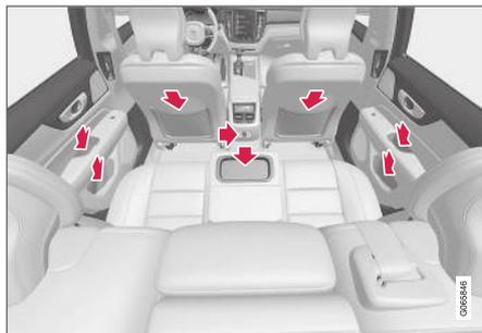
Compartimento de armazenamento no painel da porta, porta-copos\* no encosto do assento central, bolso para armazenamento\* no encosto dianteiro e tomada elétrica no console de túnel.
