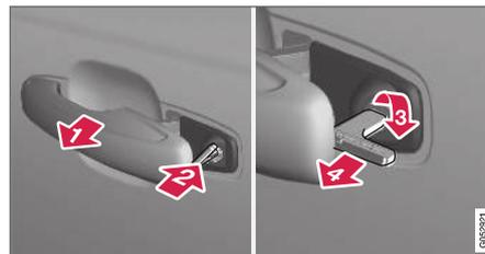
**1** Puxe para fora o maçaneta da porta do lado esquerdo<sup>9</sup> até a sua posição final, de modo que o cilindro da fechadura fique visível.
