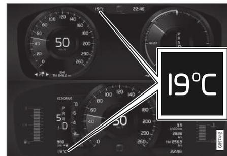
Localização do medidor da temperatura externa no visor do motorista de 12 polegadas\* e de 8 polegadas.
