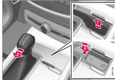
Se não for possível conduzir o veículo, por exemplo, devido a bateria descarregada, é necessário colocar o seletor de marchas na posição **N** para que seja possível deslocar o veículo.
