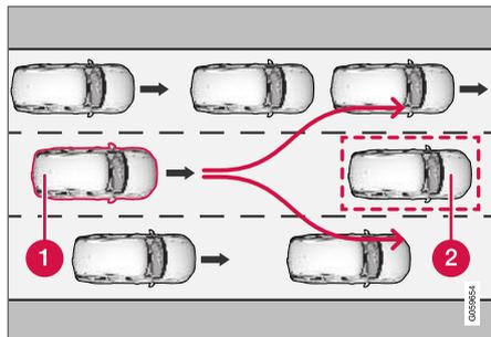
O seu veículo (1) não "enxerga" qualquer hipótese de evitar o veículo à frente (2) e freia automaticamente mais cedo.
