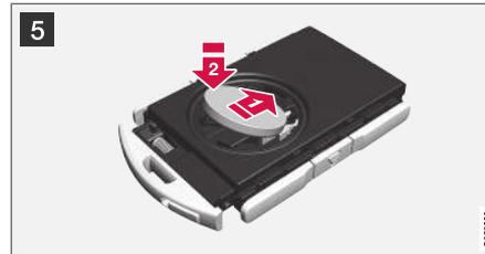
**5** Instale uma nova bateria com o lado (+) para cima. Evite tocar nos contatos da bateria da chave do controle remoto.
