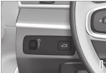
O seleto rotativo (à esquerda) para ajuste da intensidade da luz interior.
