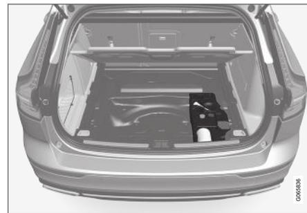
Sob o bloco de espuma no assoalho da área de carga está o gancho de reboque, o jogo de reparo de perfuração de emergência, a ferramenta para remoção das tampas de plástico dos parafusos das rodas e uma tomada para os parafusos das rodas bloqueantes.
