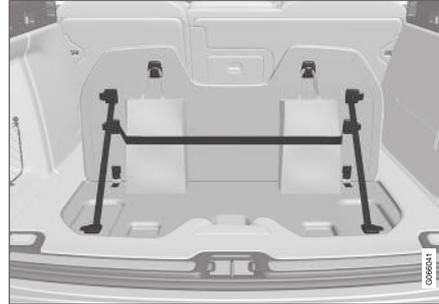
Existem dois ganchos para sacolas de compras e uma cinta elástica<sup>3</sup> na tampa, que faz parte da escotilha do assoalho, no compartimento de carga. A cinta pode ser montada de quatro formas diferentes.
