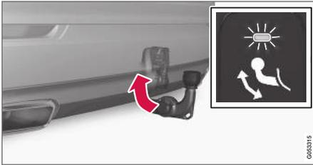
Trave a barra de reboque inserindo-a de volta para a sua posição retraída onde fica bloqueada.
