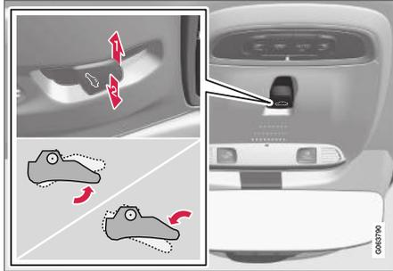
Posição de ventilação, vertical na margem traseira.
