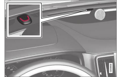
Um LED vermelho no painel de instrumentos mostra o estado do sistema de alarme:
