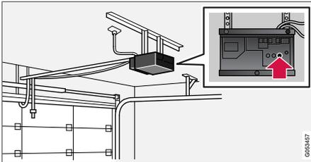
4. Procure o botão de memorização<sup>31</sup> no receptor, por exemplo, porta da garagem. Normalmente está junto à fixação da antena no receptor.
