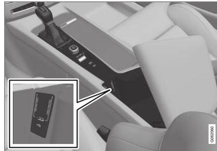
Entradas USB (tipo A) no console de túnel. Colocar os cabos para frente, para não ficarem presos ao fechar a tampa.
