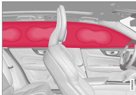
Os airbags estão montados ao longo do revestimento do teto, em ambos os lados, e ajudam a proteger o motorista e os passageiros nos assentos laterais do veículo. Os painéis estão etiquetados com **IC AIRBAG**.
