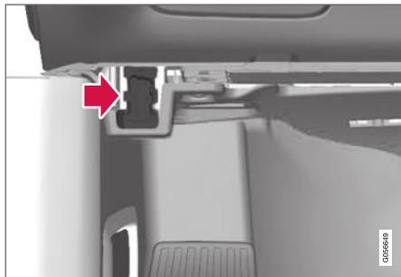
O conector de link de dados (On-board Diagnostic, OBDII) está sob o painel de instrumentos do lado do motorista.
