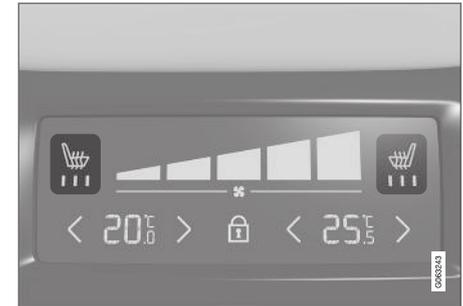
Indicação e controle do banco aquecido no painel de climatização na parte de trás do console do túnel.
