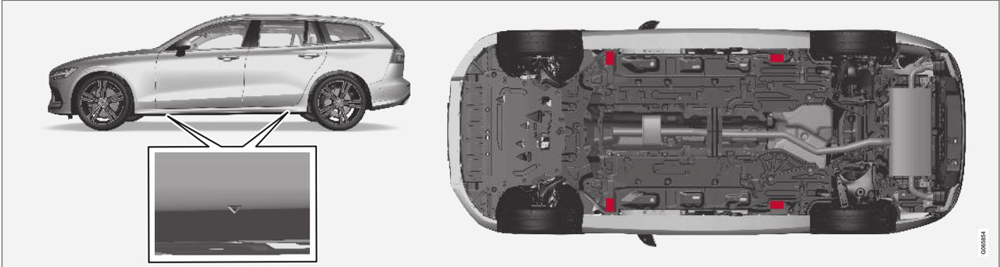
Os triângulos na cobertura de plástico apontam para as fixações do macaco/pontos de elevação (assinalados em vermelho).
