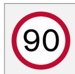
A Advertência de velocidade é efetuada através de um símbolo<sup>91</sup> do visor do motorista piscando com a velocidade máxima permitida aplicável enquanto a mesma é ultrapassada.
