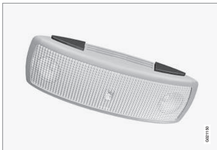
Iluminación trasera del techo.
