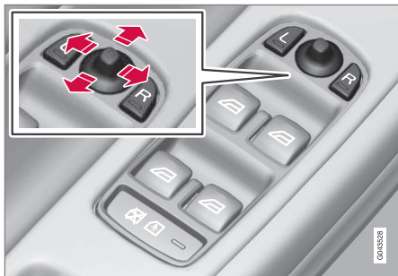
Mando de los retrovisores exteriores.
