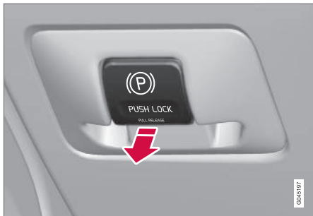
Mando del freno de estacionamiento - Liberación.
