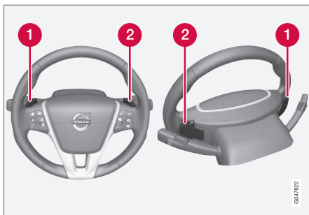
Las dos "paletas" del volante.
