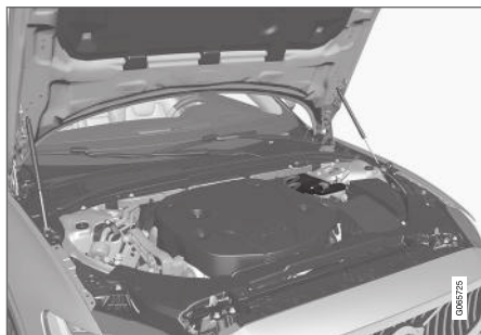
Η εφεδρική μπαταρία βρίσκεται στον χώρο του κινητήρα.
