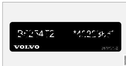
4 Πινακίδα για τον κωδικό κινητήρα και τον σειριακό αριθμό του κινητήρα.
