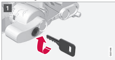
1 Włożyć kluczyk do zamka i obrócić w prawo do położenia zwolnionej blokady.
