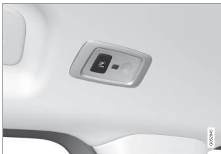
Fahrzeuge mit Panoramadach* verfügen beidseits des Dachs über je ein Leuchtenmodul. 10
