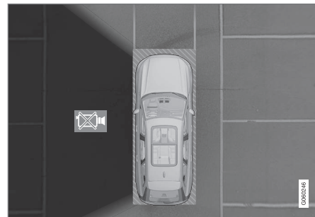
Hier ist die Kamera auf der linken Fahrzeugseite defekt.
