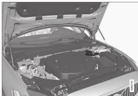
Støttebatteriet er placeret i motorrummet.
