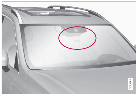
Emplacement du capteur radar
