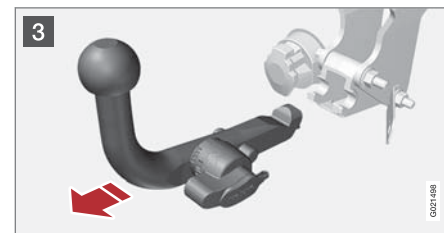
3 บิดปุ่มล็อกลงจนสุดกระทั่งถึงจุดหยุด จับไว้ในตำแหน่งนี้ในขณะที่ตั้งตะขอพ่วงออกข้างหลังและตั้งขึ้น
