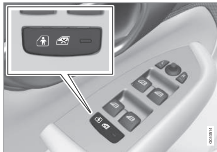
Elektrinio aktyvinimo ir išaktyvinimo mygtukas.
