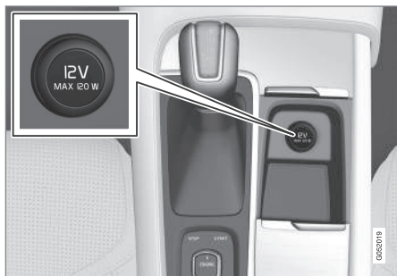
Tunnelkonsolis olev 12 V elektripistikupesa, esiiste.
