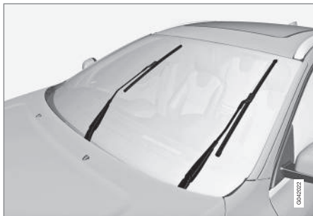
Balais d'essuie-glace en position d'entretien
