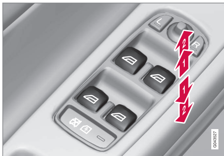
Fonctionnement des vitres électriques
