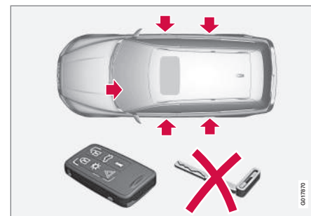
Points de verrouillage/déverrouillage lorsque le verrouillage indépendant est activé.
