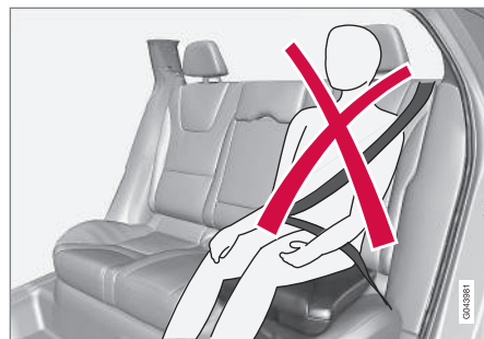
Position assise incorrecte : la tête de l'enfant dépasse l'appui-tête et le boudrier n'est pas placé en travers de la clavicule
