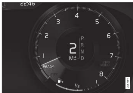
Manuel gearposition på førerdisplayet 3 .
