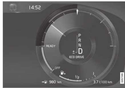
Eco-måleren på 12-tommer førerdisplay*.
