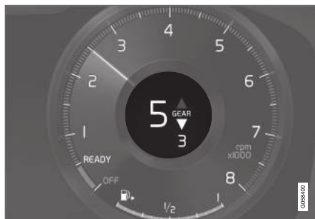
Gearskift-indikator på 12-tommer førerdisplay*.
