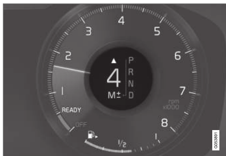
Gearskift-indikator på 12-tommer førerdisplay*.
