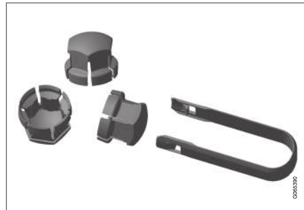
Työkalu pyöränruuvien muovihattujen poistamista varten.
