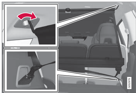
後段安裝位置。
