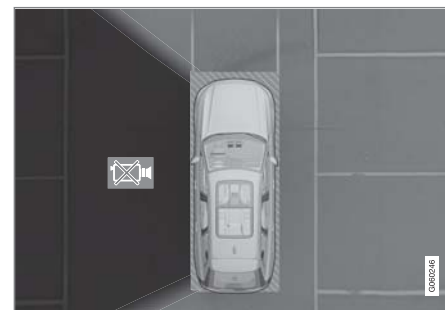
車輛左側攝影機故障。
