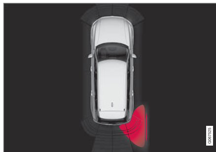
螢幕上的泊車輔助系統圖形亮起 CTA 圖標。
