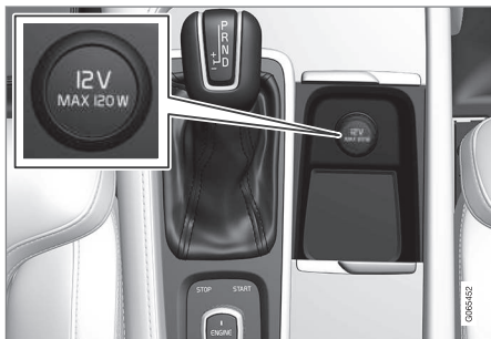
12-V-Steckdose in der Tunnelkonsole, vorn.
