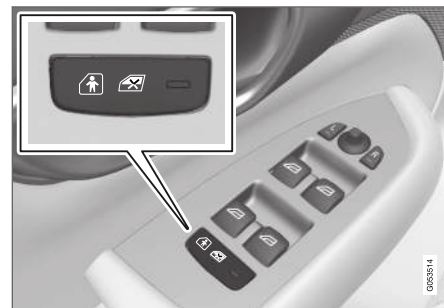
Botón de conexión y desconexión eléctrica.
