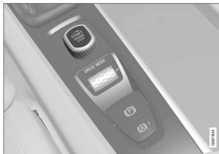
Startvredet i tunnelkonsolen.
