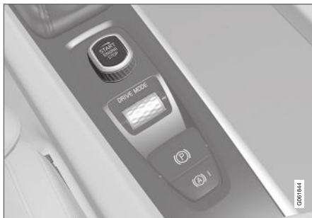
Startvredet i tunnelkonsolen.
