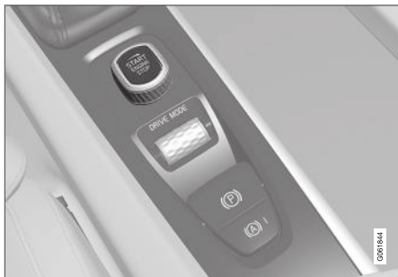
Startvredet i tunnelkonsolen.
