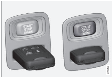
Startlås med fjärrnyckel utdragen/intryckt.
