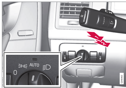
Pákový přepínač a knoflík regulace světlometů.
