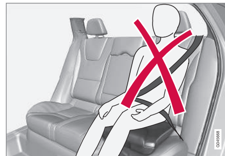
Nesprávné umístění, bezpečnostní pás nesmí vést pod ramenem.
