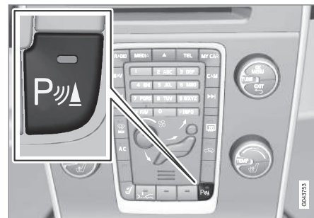
Kontrolka Zapnuto/Vypnuto parkovací asistence a funkce CTA*.
