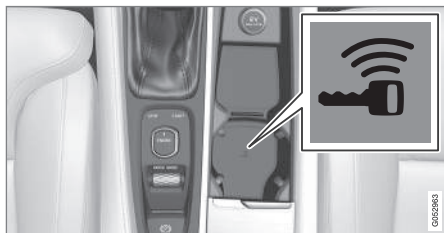
Umístění záložní čtečky v tunelové konzole.
