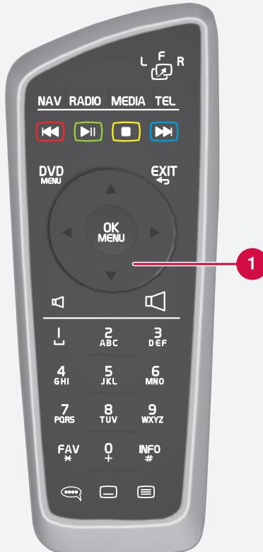
① Колесо прокрутки соответствует кнопке **TUNE** на центральной консоли.
