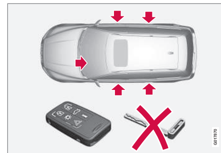
Låspunkter för fjärrnyckel utan nyckelblad och aktiverad sekretesslåsning.
