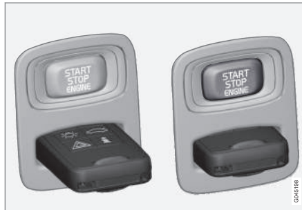
Startläs med fjärrnyckel utdragen/intryckt.
