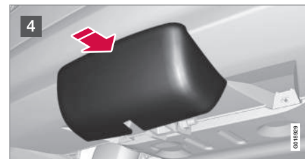
4 Skjut på skyddskåpan tills den snäpper fast.
