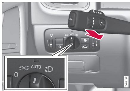
Stuurhendel en verlichtingsdraaiknop in stand AUTO .
