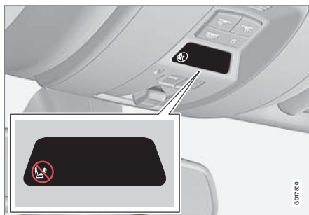
Hiermee wordt aangegeven dat de airbag aan de passagierszijde geactiveerd is.
