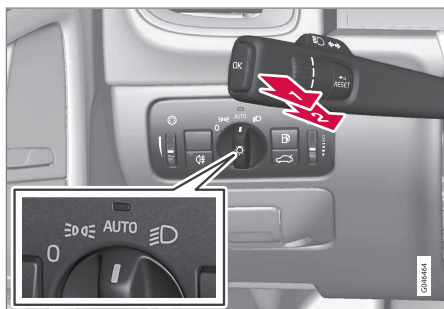
Stuurhendel en verlichtingsdraaiknop.
