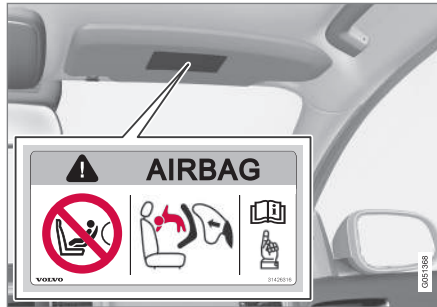
Alternatief 1: Locatie van de waarschuwingssticker voor de passagiersairbag op de zonneklep aan passagierszijde.
