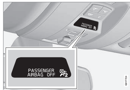
Hiermee wordt aangeduid dat de airbag aan de passagierszijde gedeactiveerd is.
