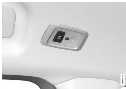
Στα αυτοκίνητα με πανοραμική οροφή* υπάρχουν δύο φωτιστικά σώματα, ένα σε κάθε πλευρά της οροφής. 7
