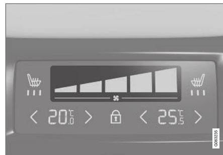
Ventilatorregeling op klimaatpaneel achter op tunnelconsole.
