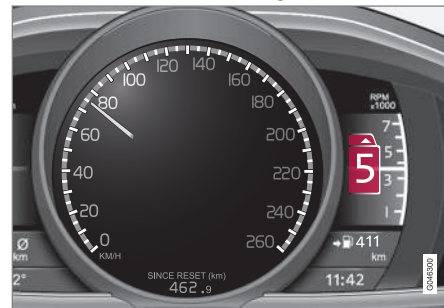
Instrumentenpaneel 'Digital' met schakelindicator.
