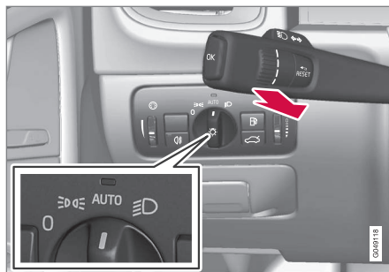
Stuurhendel en verlichtingsdraaiknop in stand AUTO .
