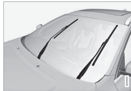
Balais d'essuie-glace en position d'entretien.
