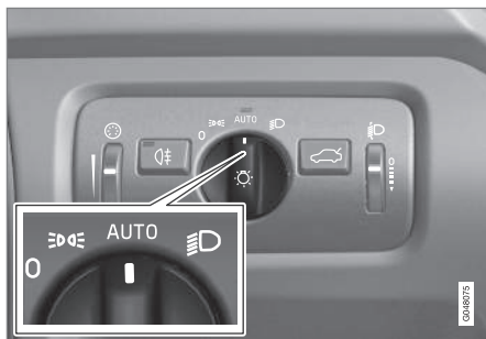
Bouton du commutateur d'éclairage en position AUTO .
