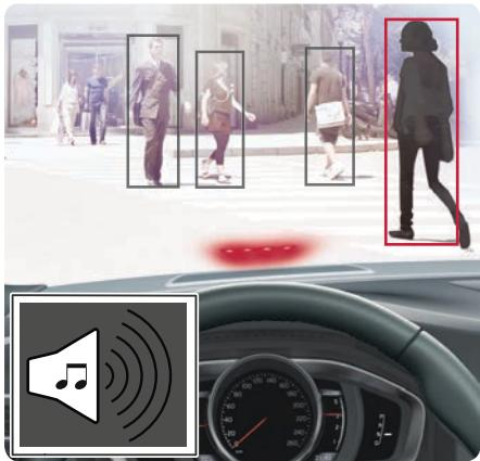
本車配備了具自動煞車功能的撞擊警示系統及自行車騎士與行人偵測系統，可為汽車、自行車騎士及行人煞車及/或停車。
