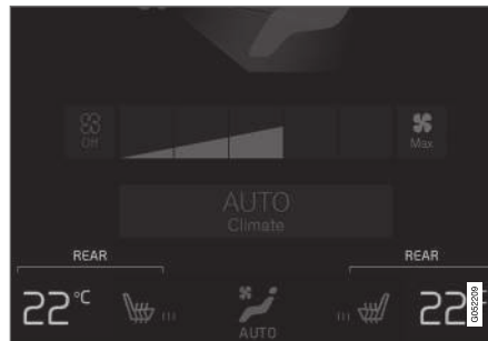
Temperaturknapper på fanen Klima bag i klimavisningen.
