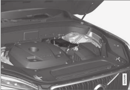
Støttebatteriet er placeret i en kasse ved siden af fjederbenstårnet.
