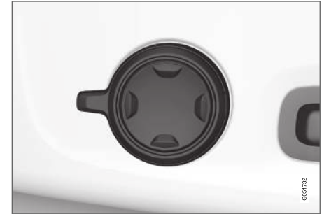
Multifunktionsknappen, placeret på siden af sædets sidedel.
