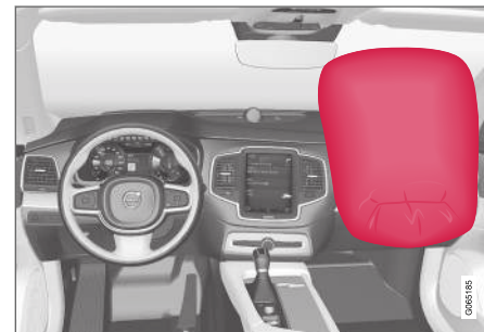
Airbag til forsædet i passagersiden
