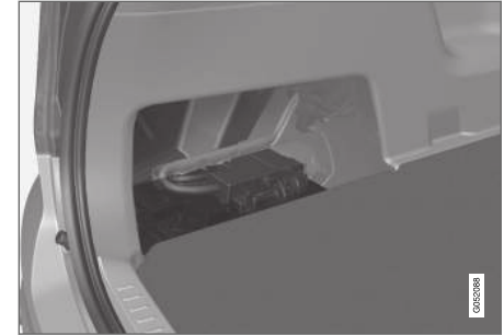
Startbatteriet er placeret i bagagerummet.
