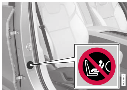
Mærkat på passagersidens dørstolpe. Mærkatens bliver synlig, når passagerdøren åbnes.
