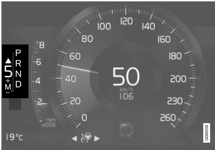
Gearskift-indikator på 8-tommer førerdisplay.
