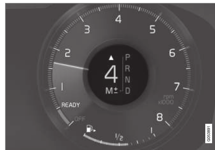
Gearskift-indikator på 12-tommer førerdisplay*.
