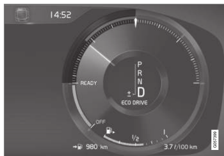
Eco-måleren på 12-tommer førerdisplay*.
