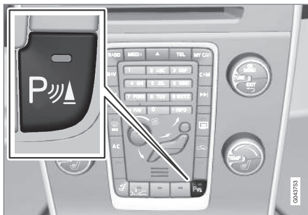
Til-/fra for sensorerne til Parkeringshjælp og CTA.
