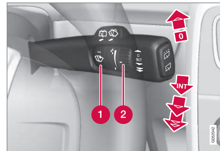
Forrudeviskere og -sprinklere.
