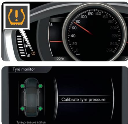
É sempre necessário proceder à calibragem após a mudança de pneu ou alteração da pressão do pneu. Quando acende a lâmpada (!) é necessário verificar a pressão do pneu e calibrar o sistema. Proceda do seguinte modo:
