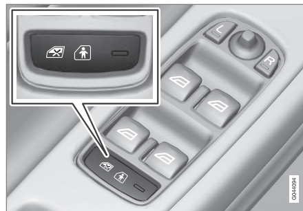
Panneau de commande porte conducteur.
