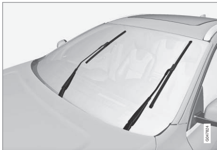
Balais d'essuie-glace en position d'entretien.
