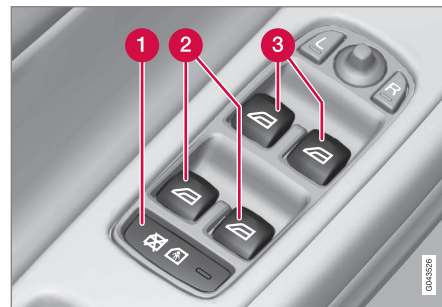
Panneau de commande de la porte conducteur.
